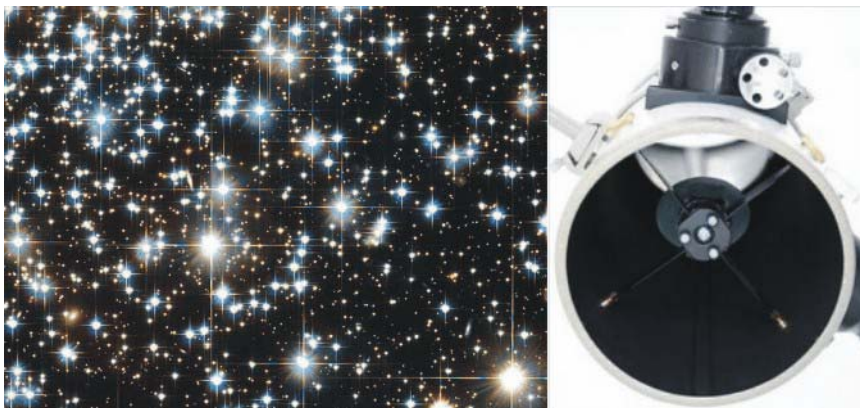
Figura 5: À esquerda, imagem do aglomerado globular NGC 6397, obtido com um telescópio de reflexão, em que aparecem picos de difração (fonte: H. Richer, NASA). Estes são “artefatos” do instrumento, causados pelos quatro suportes do espelho secundário, que aparecem na imagem à direita (câmera astronômica TS Foto Newtonian 6, da Orion Optics).
