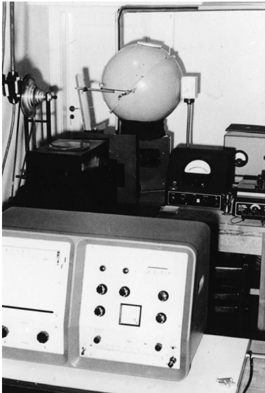
Abb. 2 Experimenteller Aufbau zur Messung von Strahlungsintensitäten mit einer Ulbricht'schen Kugel und einem Bolometer in Warburgs Institut, 1962. Derartige Instrumente wurden am MPI für Biochemie zur Untersuchung der das Bakteriorhodopsin enthaltenden Halobakterien verwandt. 4 Veröffentlicht mit freundlicher Genehmigung des Archivs der MPG, Berlin-Dahlem
