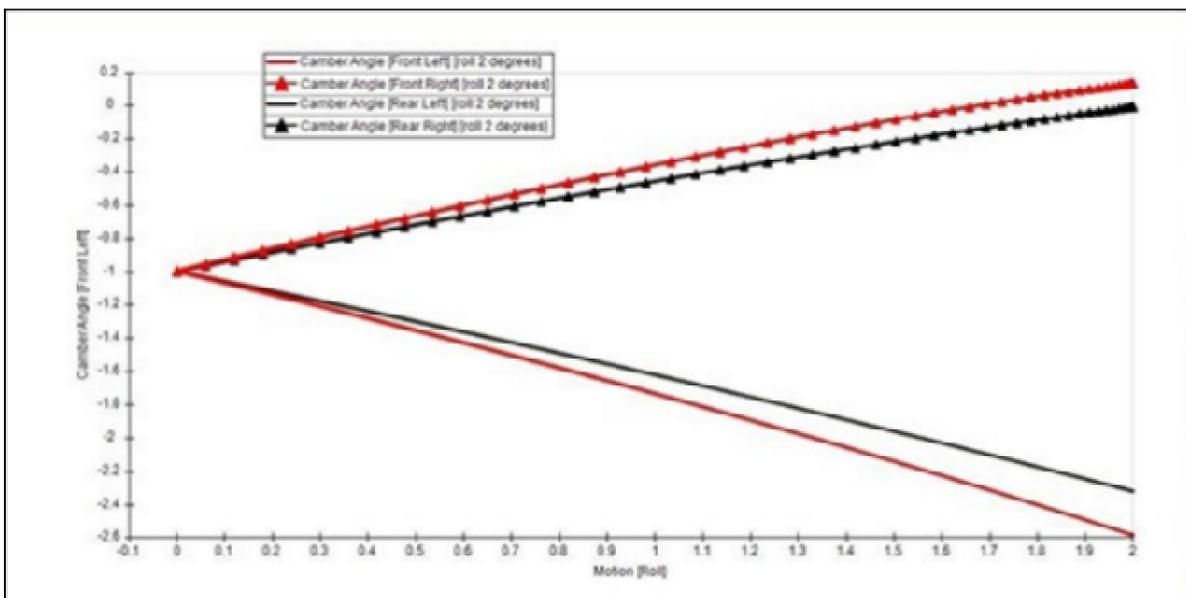
Fig. 12. Camber angle (v.s) Roll motion
