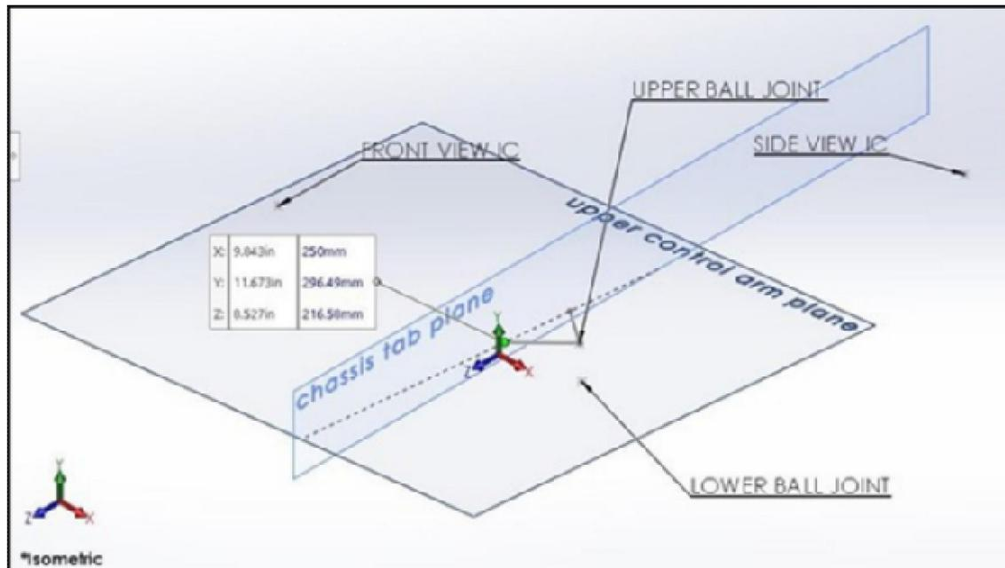
Fig. 6. A-arm line diagrams
