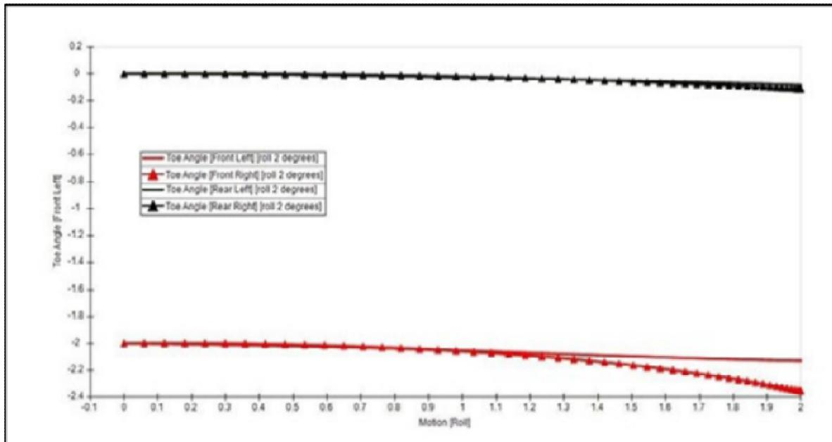
Fig. 15. Toe angle (v.s) Roll motion
