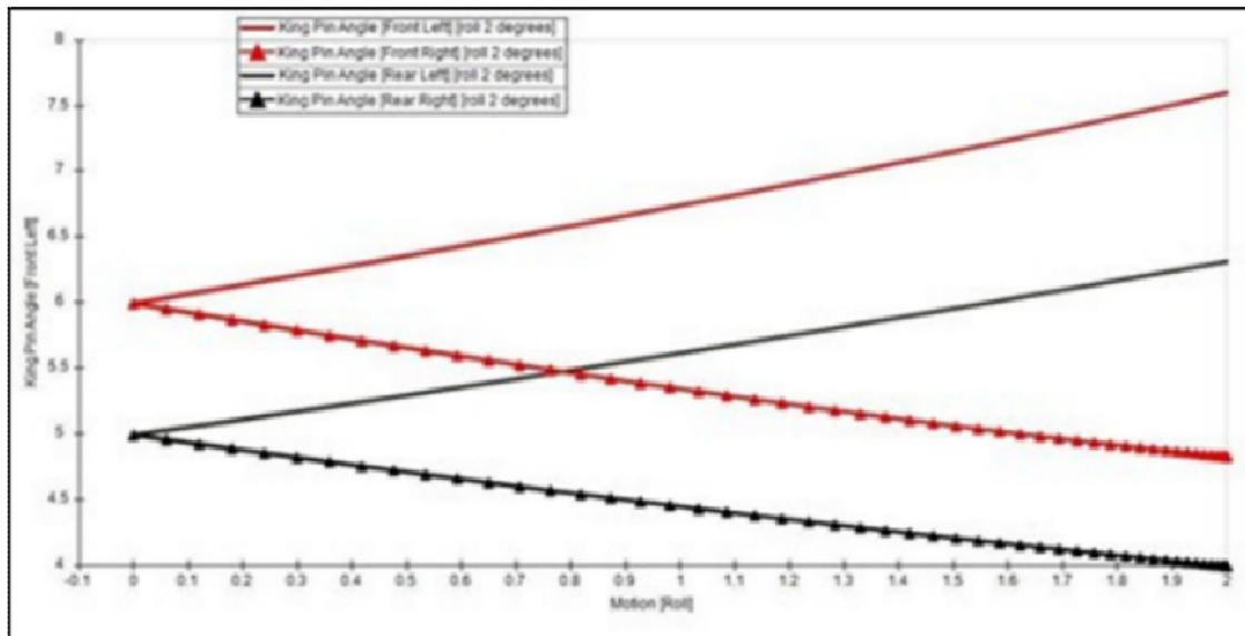
Fig. 14. Kingpin angle (v.s) Roll motion
