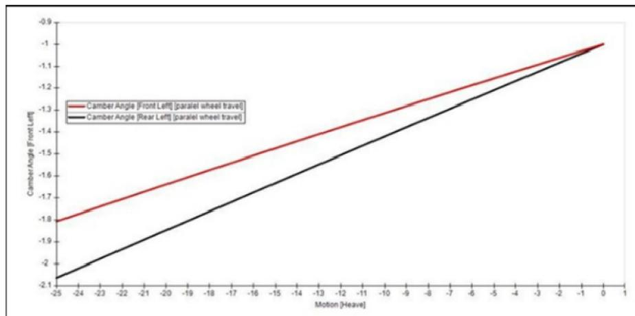
Fig. 8. *Camber angle (v.s) Heave Motion*
