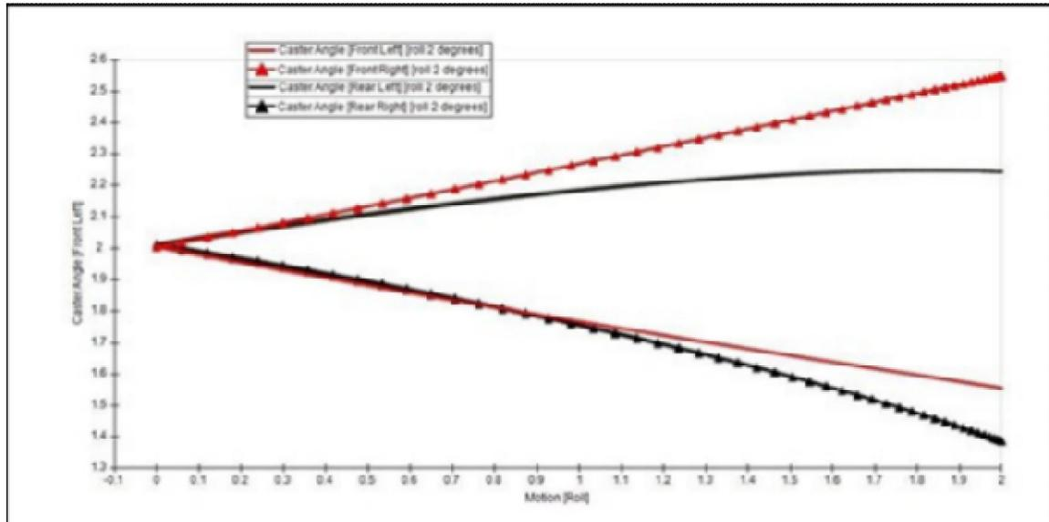
Fig. 13. Caster angle (v.s) Roll motion
