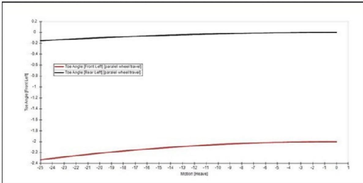
Fig. 11. Toe angle (v.s) Heave motion
