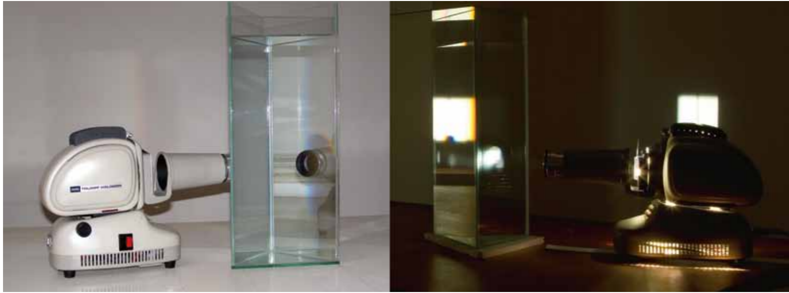
Abb. 2 Projektor und Wasserprisma in Nussbauers Dunkelkammer [I.N. 2009]. In Nussbauers Variante des newtonischen Experiments (Abb. 1) wird das Prisma nicht vom Sonnenlicht beleuchtet, sondern vom Licht eines Diaprojektors (der das Bild eines sog. Spalt-Dias aufs Prisma projiziert). Das Licht der Projektionslampe ist zwar schwächer als das der Sonne, unterscheidet sich aber in seiner Zusammensetzung kaum vom Sonnenlicht.
