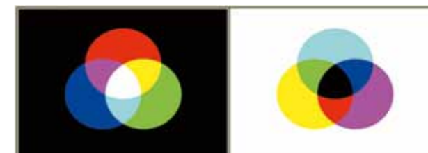
Abb. 24 Zwei siebenfache Farbsynthesen [Graphik: Ingo Nussbaumer [zF]: 133]. Links die Synthesen aus dem ursprünglichen Experiment (Abb. 23 oben), rechts deren Kontrapunkt (Abb. 23 unten). Die beiden Diagramme sind aus einem anderen Zusammenhang bekannt: Links sog. additive, rechts sog. subtraktive Farbmischung.
