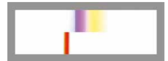
Abb. 19 Nussbauers Rotsynthese [I.N. 2009]. Oben zeigt die Abbildung ein Photo des Komplementärspektrums, aus dem der linke türkisfarbene Teil (durch Überblendung) beseitigt wurde. Unten zeigt sie das Bild, das die Kamera liefert, wenn man dies fragmentierte Spektrum (ohne Türkis) durchs analysierende Prisma hindurch fotografiert. Purpur und Gelb aus dem Komplementärspektrum (also all seine Farben außer Türkis) werden wieder zusammengezogen und mischen sich zu Rot.
