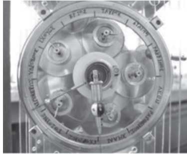
Figura 8. Modelo interpretativo que explica como o mecanismo estabelecia a posição dos planetas através dos cinco pequenos relógios subsidiários. (Carman, 2011:35 cortesia de Michael Wright).
