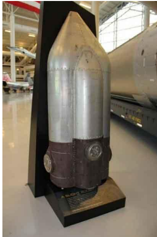
Рис. 4 Двигуни для осадження палива другого ступеня ракети Сатурн V. [7]
