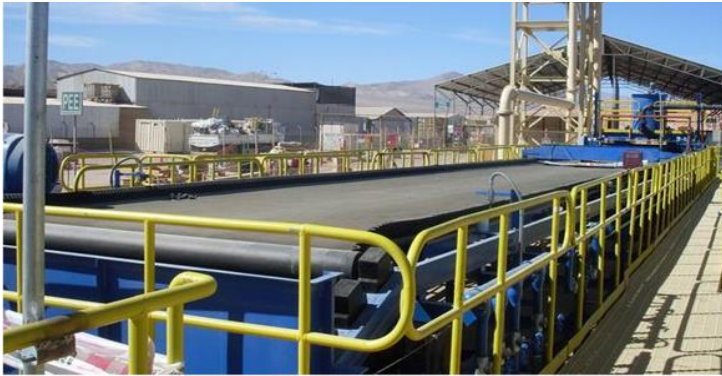
Рисунок 2 – Horizontal Belt Filter from BASPA company (Горизонтальний стрічковий фільтр від компанії BASPA) [3]
