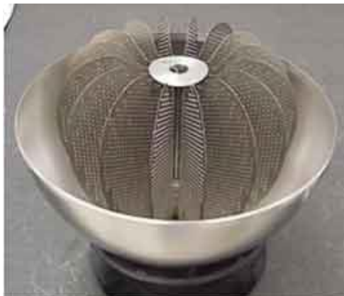
Рис. 6 Система тотального контролю палива на основі сітчастих екранів [11].
